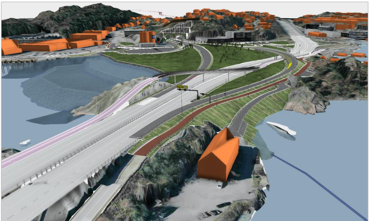
Figur 4-55: Avkjøringsrampe over E18 og lokalvei til Varoddan.
