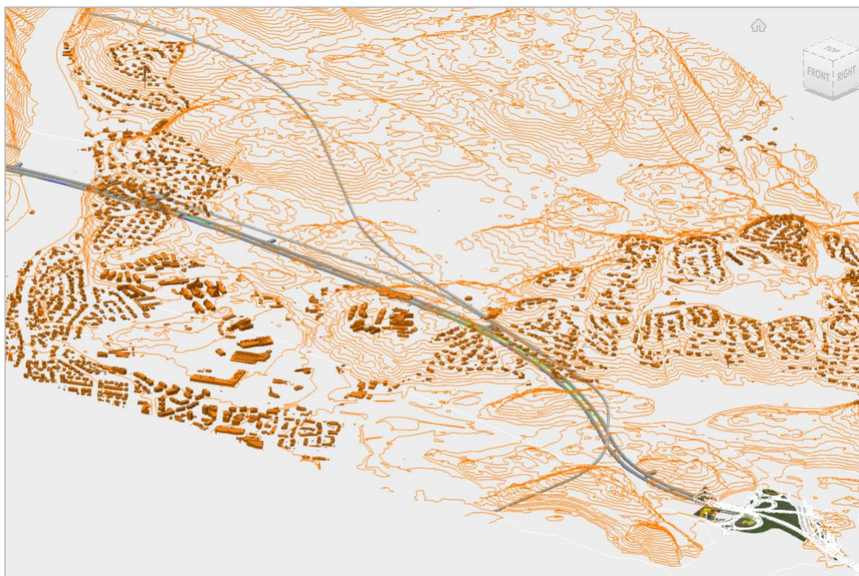
Figur 4-51: Jernbanetunnel ligger parallelt med Otratunnelen langs en strekning vest for Vige, men i et annet plan.
