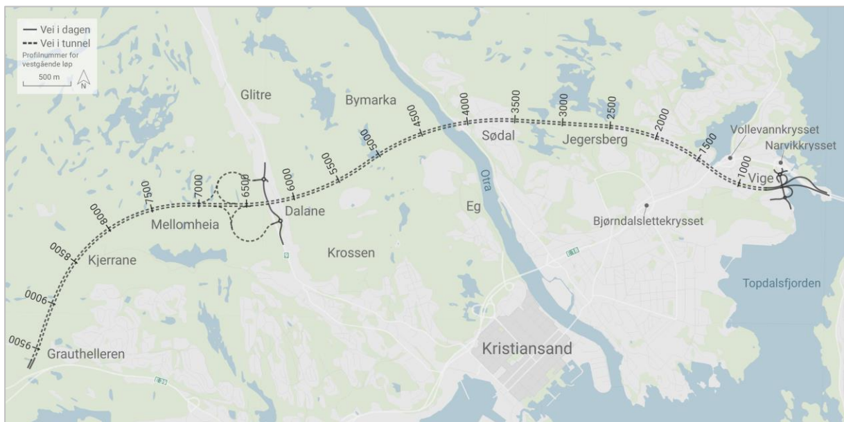
Figur 4-1: Oversikt over Ytre ringvei. Store deler av veiltaket ligger i tunnel. Hovedtunnelen er kalt Otrattunnelen.
